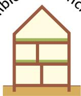
En soufflage entre solives ou sur plancher en combles perdus (35kg/m<sup>3</sup>).
